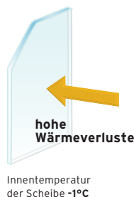
Einfachverglasung Außentemperatur -12°C Innentemperatur +20°C
